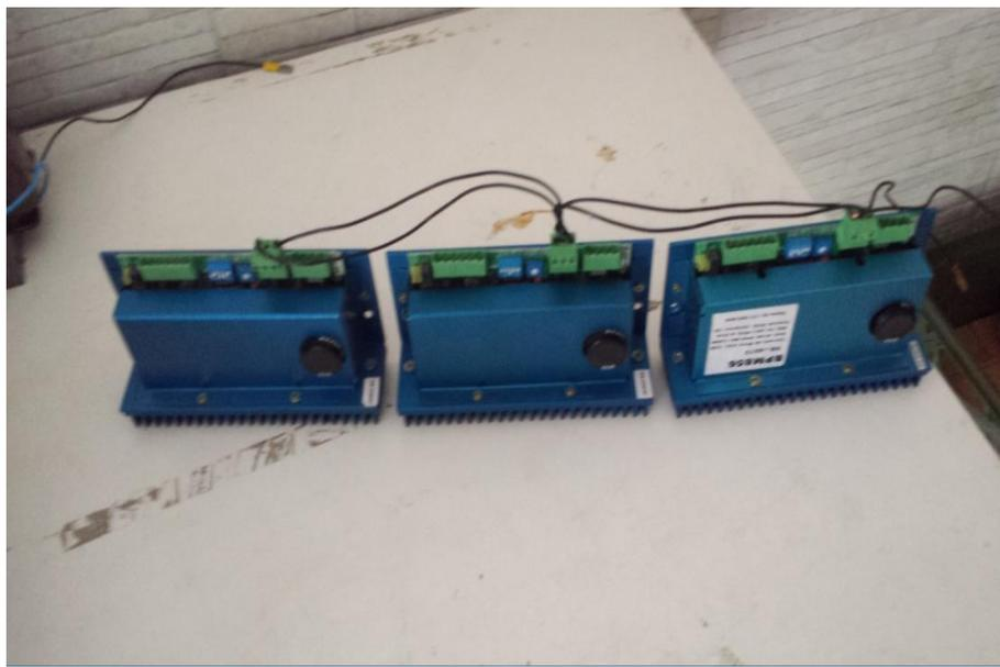
Figura 7. Drives de alimentação Photon Bpm856 - 3200 pulsos
