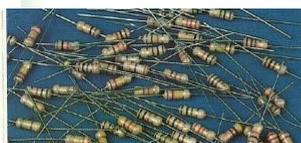
**Figura 26-7** Resistores variados. As faixas coloridas indicam o valor
