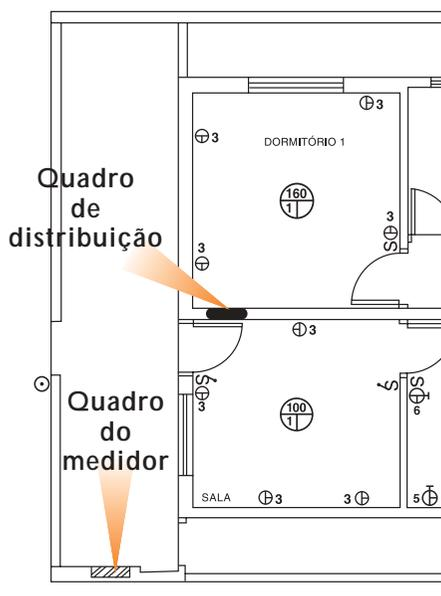
Uma vez determinado o local para o quadro de distribuição, inicia-se o caminhamento partindo dele com um eletroduto em direção ao ponto de luz no teto da sala e daí para os interruptores e tomadas desta dependência. Neste momento, representa-se também o eletroduto que conterá o circuito de distribuição.
