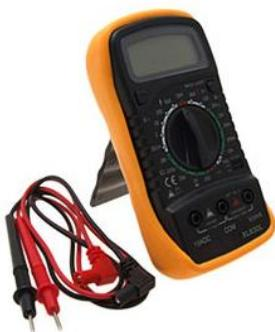
**A resolução refere-se a precisão de leitura que este equipamento pode realizar em uma medição.** Conhecendo a resolução de seu equipamento, você pode determinar se é possível visualizar uma pequena variação no sinal medido.
