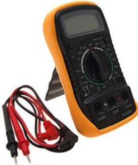
Já a precisão típica de um multímetro digital está entre  $\pm (0,7\%+1)$  e  $\pm (0,1\%+1)$  da leitura e são eliminados os erros de leitura e a impedância de um bom multímetro digital está sempre acima de vários Mega Ohms
