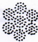
d) **Setorial Normal:** É um cabo múltiplo, tendo os seus condutores-polos em forma de setores, os quais são formados por fios de seção circular. O cabo perde um pouco da flexibilidade, pois são reduzidos apenas os espaços entre seus polos.
