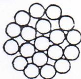
b) **Circular Compacta:** Formado por varios fios de seção circular que depois de encordoados são compactados, reduzindo-se os espaços internos, tendo-se um cabo de reduzido diâmetro e razoável flexibilidade.
