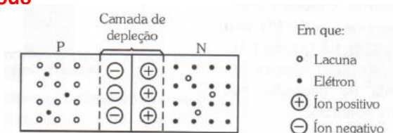
Figura 1.14 - Junção PN e a barreira de potencial.
