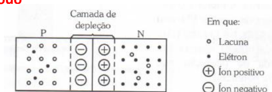
Figura 1.14 - Junção PN e a barreira de potencial.
